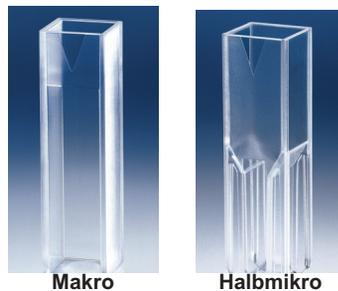
Einweg-Küvetten aus optischem PS mit optimaler Transmission von 340 bis 900 nm oder aus PMMA mit einem Anwendungsbereich von 300 bis 900 nm.
