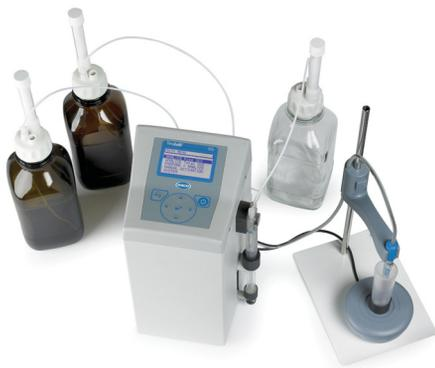
Dieser automatische Analysator ist speziell für die potentiometrische Titration entsprechend der Ripper-Methode zur Bestimmung des freien SO<sub>2</sub>- und Gesamt-SO<sub>2</sub>-Gehalts in Wein konzipiert.
