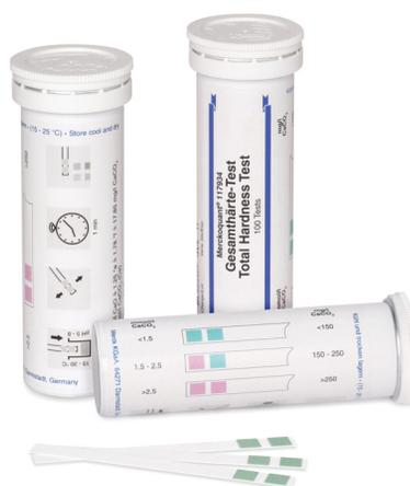
MQuant™ (MQ) Teststäbchen stellen ein Labor auf nur wenigen Quadratmillimetern dar. Als Screening-Verfahren bieten die Teststäbchen dem Anwender einen raschen Überblick darüber, ob und welche weiterführende Analysen notwendig sind. Diese gezielte Vorauswahl hilft viele zeit- und kostenaufwendige Analysen einzusparen. Die Stäbchen, die aus einer biologisch abbaubaren Polyesterfolie bestehen sowie der geringe Reagenzieninhalt in den Reaktionszonen ermöglichen eine problemlose Entsorgung.
