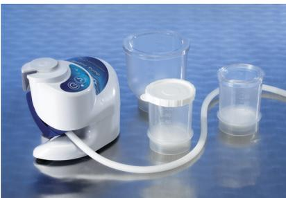
Das Sentino™ Pumpensystem eignet sich ideal für mikrobiologische MF-Techniken, bei denen Pall MicroFunnel™ Filtrationseinheiten zum Einsatz kommen. Die Probe wird mittels Peristaltik durch den Filter gezogen und das Filtrat direkt in den Abfluss oder zur Abfallsammlung befördert. Das Gehäuse besteht aus einem PC-ABS-Polymergemisch, Tastatur und Etikett aus PE, der Pumpenkopf aus PEI mit PTFE-gefüllten PBT-Rollen. Der Flüssigkeitssystemadapter besteht aus PP.
