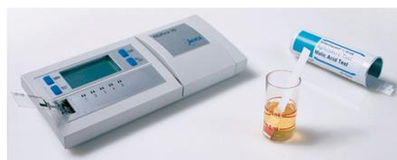
Kleine, kompakte, batteriebetriebene Messgeräte (Taschenreflektometer) für die schnelle und quantitative Analyse unterschiedlicher Proben und Parameter durch die Auswertung von speziellen Teststäbchen. Das RQflex® 10 plus bietet zusätzlich die Möglichkeit, speziell entwickelte Küvettentests auszuwerten, die eine deutlich niedrigere Nachweisgrenze oder als Teststäbchen nicht erhältlich sind.
