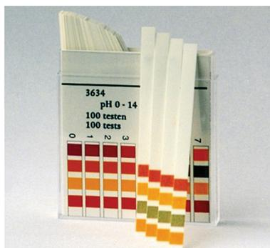
Die Teststäbchen enthalten Indikatorfarbstoffe, die kovalent an die Reagenzpapiere gebunden sind und so an den Plastikstäbchen haften. Dies verhindert ein Ausbluten des Indikators in die Probe, selbst in stark alkalischen Lösungen oder bei längerem Eintauchen in eine schwach gepufferte Lösung.
