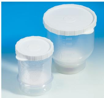
Das Produkt dient gleichzeitig als Probennahmegefäß und Filtrationseinheit. Kein Umfüllen der Probe mehr vom Entnahmegefäß in den Einwegfilter, d. h. kein Kontaminationsrisiko. Der belüftete, einrastende Deckel ist flüssigkeitsdicht und ermöglicht die Filtration ohne Öffnen des Trichters.
