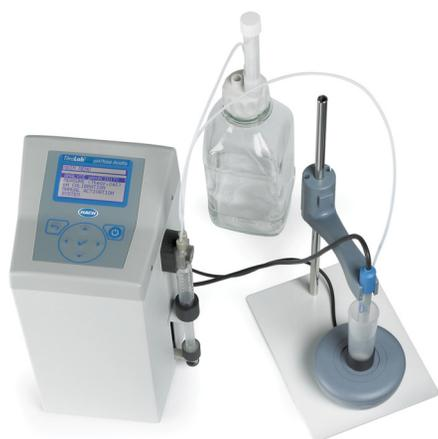
Diese automatischen potentiometrischen Titrationsanalytoren sind speziell zur Bestimmung von pH und Gesamtsäure in verschiedenen Lebensmitteln und Getränken konzipiert und bieten eine kompakte und zuverlässige Lösung für routinemäßige QK-Analysen.
