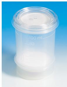
Gebrauchsfertiges, steril geliefertes 47 mm-Einwegsystem für mikrobiologische Analysen mittels Membranfiltration. Das System macht Spülen und Sterilisieren von wiederverwendbaren Trichtersystemen überflüssig und ermöglicht so eine wesentliche Zeiteinsparung bei der täglichen Routinearbeit. Die Membran wird durch einen einfachen Handgriff entnommen und steht so für die Kultivierung auf Agarplatten und Selektivtests zur Verfügung.
