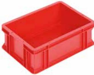
LogiLine-Behälter in Euro-Standard-Massen sind abgestimmt auf die Palettennorm 1200 x 800 / 1200 x 1000 und beliebig, auch gemischt, stapelbar. Optimales Nutzvolumen, lediglich 2 mm Konizität. Hergestellt aus Polypropylen Copolymer PPC, erfüllen sie die einsch. gesetzl. Lebensmittelverordnungen. Sie sind äusserst chemikalien- und säurefest, temperaturbeständig bis 130°C (waschbar), hygienisch und langlebig. Sehr hohe max. Stapelbelastung bis 800 kg.
