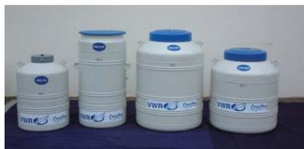
Die Behälter der Serie BSS bieten verschiedene Lösungen zur Aufbewahrung von Kryoröhrchen oder Pailletten in Flüssig- oder Gasphase. Sie gewährleisten selbst bei einem Pegel von nur 2 cm Flüssigstickstoff über der Gestellisolation (oder 5 cm über dem Boden beim BSS-5100) eine äußerst gute Temperaturkonstanz.
