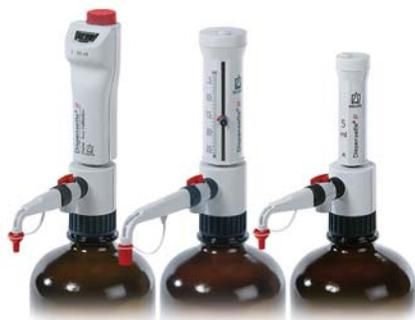
Zum Dosieren aggressiver Reagenzien, z. B. konzentrierter Säuren ( $H_3PO_4$ ,  $H_2SO_4$ ), konzentrierter Laugen (NaOH, KOH), Salzlösungen sowie einer Vielzahl organischer Lösungsmittel. Medienführende Teile aus Borosilikatglas, Keramik, Platin-Iridium, ETFE, FEP, PFA und PP (Kanülenschraubverschluss). Farbcode: Rot.
