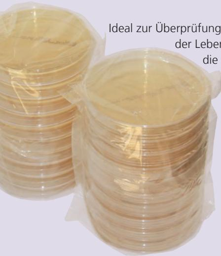
Ideal zur Überprüfung der mikrobiologischen Kontamination von Oberflächen und Luft in Reinräumen, Isolatoren, RABS, in der Lebensmittelindustrie und in Krankenhäusern. Die Dreifachverpackung sorgt dafür, dass die Packung selbst die Umgebung nicht verunreinigt, wenn die erste Verpackungslage direkt vor Betreten des Reinraums entfernt wird.
