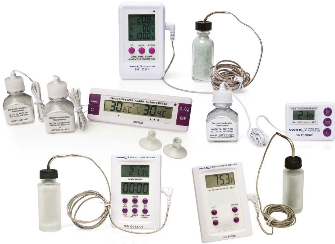
Digitalthermometer zur Verifikation der Temperatur von Proben in Gefriergeräten, Kühlschränken, Inkubatoren und Öfen. Genaue Temperaturmessung ohne das Risiko der Kontamination der Probe bei Verwendung der gefüllten Flasche (im Lieferumfang enthalten), die die Probe imitiert.
