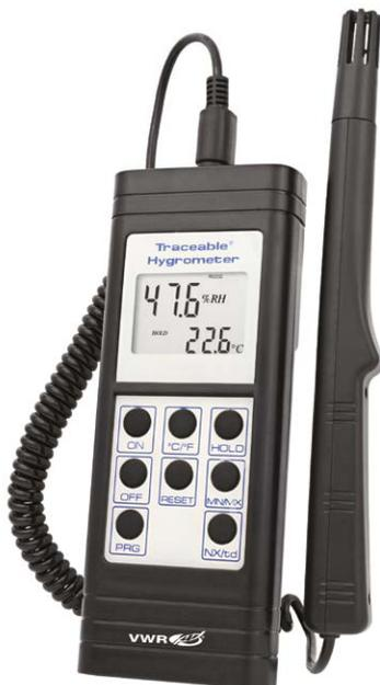
Dieses Thermo-Hygrometer misst die Temperatur und relative Feuchtigkeit und zeigt beide Werte auf einem Doppel-LCD-Display an. Zur Überwachung der Bedingungen in Reinräumen, Computerräumen, Lagereinrichtungen und überall dort, wo Temperatur und Feuchtigkeit wichtige Komponenten und Tests beeinträchtigen können.
