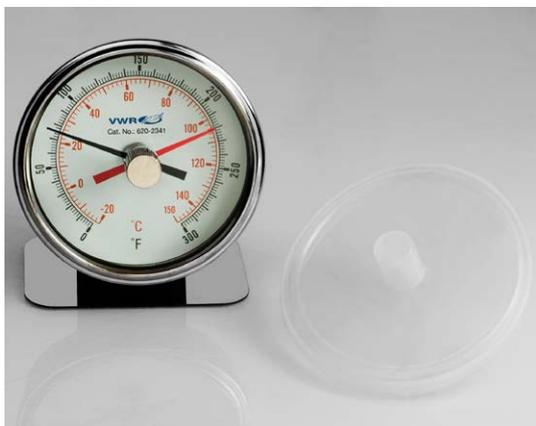
Dieses robuste Thermometer verfügt über einen Maximalwertzeiger (rot), der durch den Temperaturmesszeiger (schwarz) nach oben geschoben wird und somit die höchste Temperatur anzeigt. Der Gewindeanschluss (1/4» NPT) kann verwendet werden, um das Thermometer auf dem mitgelieferten Stativ festzuschrauben.
