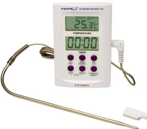
Diese hochpräzisen Digitalthermometer mit chemikalienbeständigen Föhler sind für die Überwachung der Temperatur von Pharmazeutika, Impfstoffen, Chemikalien, Blut und Blutprodukten, Lebensmitteln usw. konzipiert.
