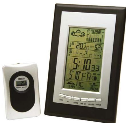
Diese Wetterstation verfügt u. a. über einen Kalender mit Datum bis zum Jahr 2099, Zeitanzeige (wahlweise 12- und 24-Stunden-Modus), Alarm mit Schlummerfunktion, Mondphase, Gezeitenanzeige, Uhrzeit für Sonnenauf- und -untergang, Luftdruckmessungen mit animierter Wettervorhersage, Minimum-/Maximum-Speicher für Hygrothermometer, drahtloses Funk-Hygrothermometer für Verbindung mit bis zu drei Fernmessfühlern.
