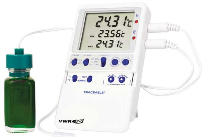
Die Lieferung aller Traceable®-Thermometer erfolgt zur Sicherstellung der Genauigkeit mit einem einzeln nummerierten Traceable® Zertifikat für Mehrpunktkalibrierung eines von der A2LA gemäß ISO/IEC 17025:2005 (1750.01) akkreditierten Kalibrierlabors. Es gewährleistet die Rückführbarkeit nach NIST-Standards (National Institute of Standards and Technology, dt.: Nationales Institut für Standards und Technologie).
