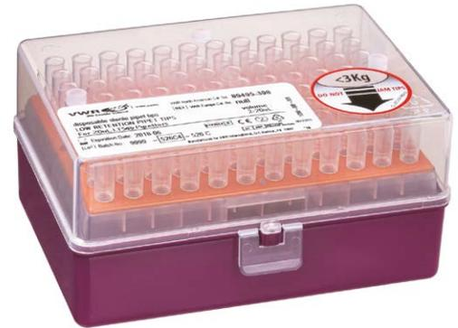
Im Gegensatz zu vorsterilisierten Pipettenspitzen anderer Marken wird bei diesen Spitzen ein validiertes Sterilisationsverfahren (ISO) angewandt. Die Spitzen können daher für die medizinische Forschung und Diagnostik eingesetzt werden.
