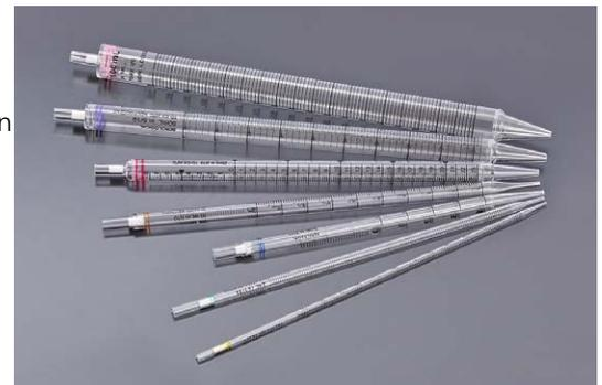
Gefertigt in einer Reinraumumgebung der Klasse 100 000. Gefertigt gemäß der Qualitätsmanagementsysteme EN ISO 13485:2003 und ISO 9001:2008.
