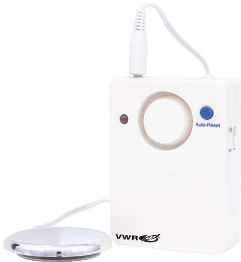
Kann eingesetzt werden um festzustellen, wenn Fässer, Tanks, Kolben oder Becher kurz vor der Überfüllung stehen. In dem Moment, in dem die Flüssigkeit den Sensor berührt, ertönt der Alarm und ein rotes Licht blinkt kontinuierlich bis die Flüssigkeit den Sensor nicht mehr berührt.
