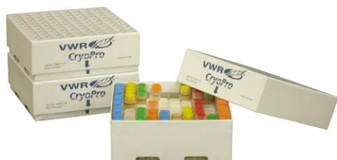
Boxen und Rastereinsätze sind aus langlebigem Karton mit schützender, feuchtigkeitsabweisender Beschichtung hergestellt. Flüssigstickstoff (LN<sub>2</sub>)-Kryoboxen verfügen über Schlitze für den sicheren LN<sub>2</sub>-Abfluss und reduzierten LN<sub>2</sub>-Verbrauch. Kryoboxen für mechanische Gefriergeräte haben keine Schlitze und können nicht mit LN<sub>2</sub> verwendet werden.
