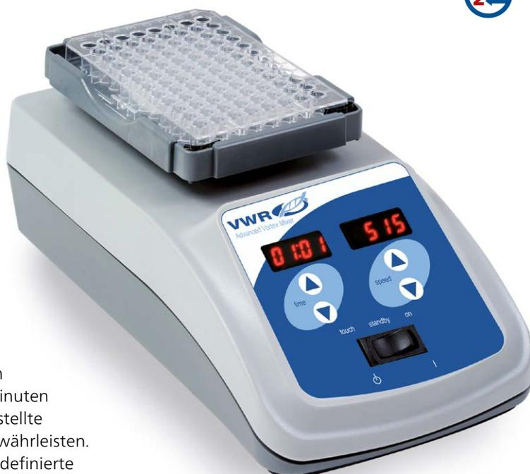
Das Gerät bietet Touchpad-Bedienelemente und LED-Anzeigen für genaue Resultate in Bezug auf Drehzahl (min<sup>-1</sup>) und Zeit (Minuten und Sekunden). Seine Mikroprozessorsteuerung hält die eingestellte Drehzahl konstant, um ein starkes, konsistentes Mischen zu gewährleisten. Die Zeitschaltuhr zeigt die verstrichene Zeit oder eine benutzerdefinierte Zeitvorgabe an oder schaltet das Gerät nach Ablauf der eingestellten Zeit ab.
