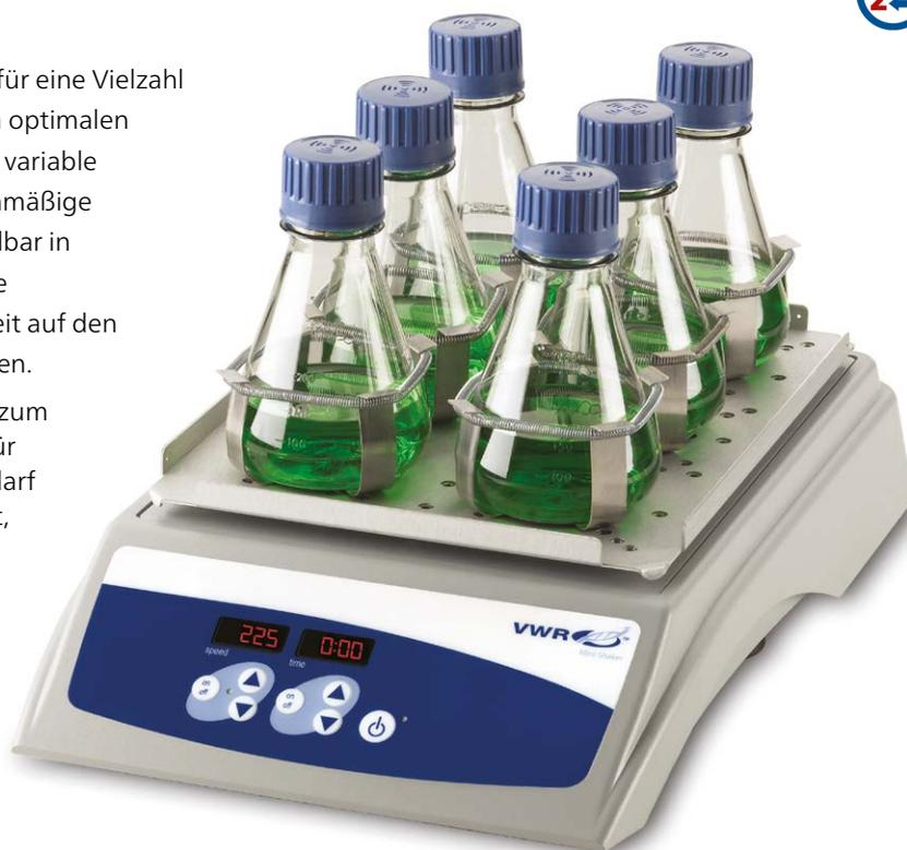
Das Gerät verfügt über einen Überlastschutz: Akustische und visuelle Signale werden aktiviert, wenn das System eine Blockierung oder Überlastung des Trays erkennt. Geeignet für Anwendungen mit Zellkulturen, Bakteriensuspensionen, ELISA und Löslichkeitsexperimente in der Biotechnologie, Pharmazie, Gesundheitswesen, in Universitäten und Behörden.
