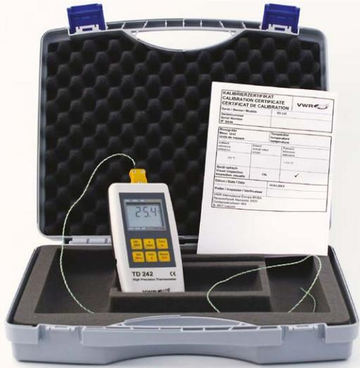
Diese einsatzbereiten Thermometer mit Fühler sind für Temperaturmessungen mit einer hohen Genauigkeit vorgesehen. Sie können für allgemeine Anwendungen in Luft, Gas, Flüssigkeiten und Feststoffen verwendet werden (abhängig vom Fühlertyp). Sie eignen sich für pharmazeutische und biotechnologische Unternehmen (Fertigung und Labors, in der Lebensmittelindustrie für Milchprodukte, Fisch, Fleisch), das Gesundheitswesen, Blut, Behörden und den Umweltbereich.
