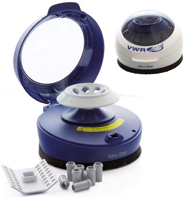
Diese Zentrifuge verfügt über eine feste Drehzahl von 6000 min<sup>-1</sup>/2000 xg und ist für Anwendungen ausgelegt, die relativ niedrige g-Werte erfordern, beispielsweise Mikrofiltration, Zellseparation und schnelles Abzentrifugieren von Röhrenwänden.
