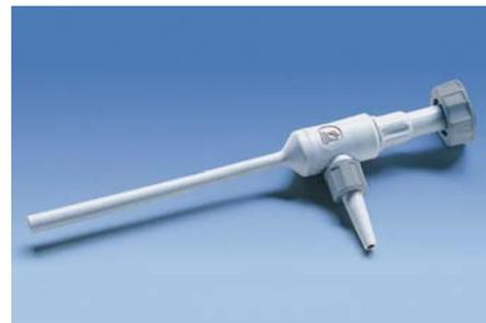
**Lieferumfang:** Umfasst die Wasserstrahlpumpe und für den Wasseranschluss: eine Überwurfmutter R 3/4», ein Reduzierstück R 1/2», und Schlauchanschluss (Olive) mit Außen-Durchmesser 10-12 mm. bzw. für den Vakuumanschluss: Olive mit Außen-Durchmesser 6-9 mm, abschraubbar mit Schraubkappe GL 14.
