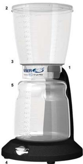
1. Quick-Connect™ Standfuß oder Halterungsring ermöglichen eine freihändige Filtration; die Beschwerung bietet zusätzliche Stabilität
