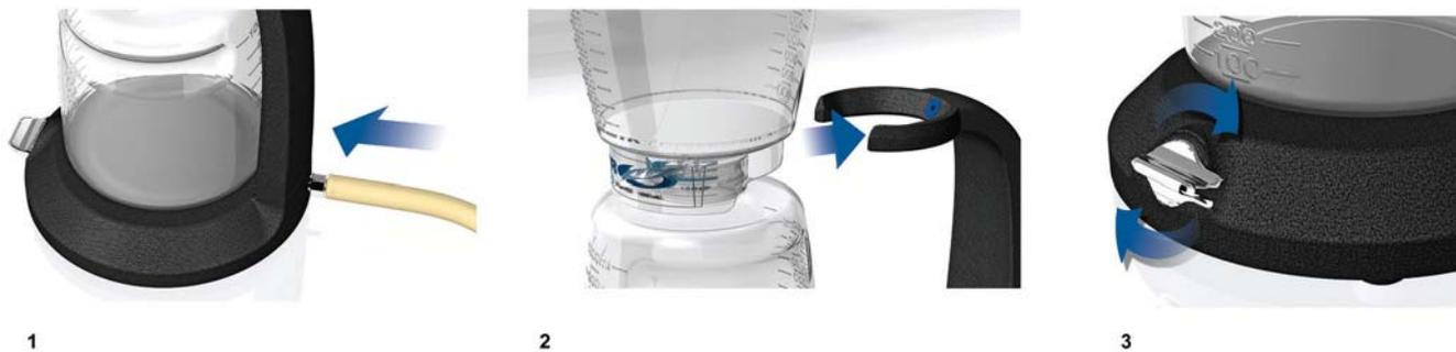
1. Vakuumschlauch einmalig an der Rückseite des Quick-Connect™ Standfußes anschließen
